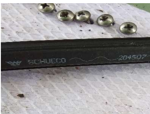
Abb. 75: innere Glasdichtung 204507 Schüco
