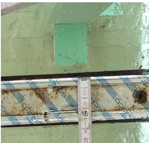
Abb. 73: Butylbandbreite 35-45mm gemessen
